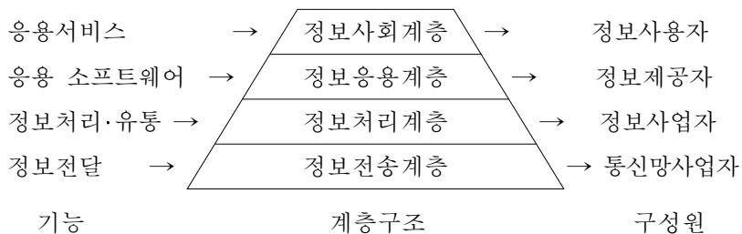
[圖 IV-1] 超高速情報通信基盤의 階層的 構造
