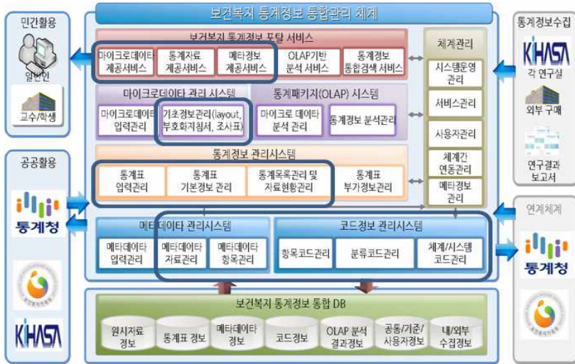
[그림 1] 보건복지통계정보시스템 목표시스템 구성도
